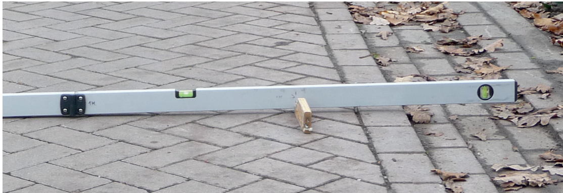
Afb. 4 Dwarsprofiel: meting van het dwarsafschot in de rijbaan met behulp van rei/waterpas en meetplankje
