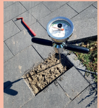
Afb. 18 v.l.n.r.: klik bij kolk en in gootlagen bij molgoot, verband straatbakstenen, meting verdichting zandbed
