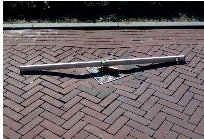
Afb. 7 Vlakheid: twee gevallen van 'onvlakheden' in straatwerk. Links: de onvlakheid wordt gemeten onder de rei met de 'meetwig'. Rechts: onder de rei met het 'meetplankje'.
