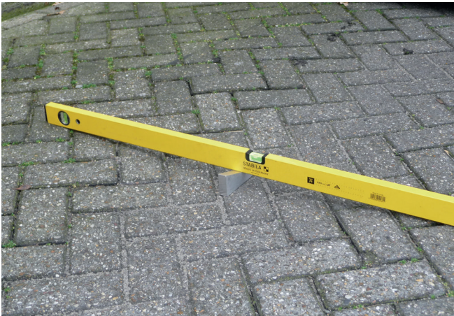
Afb. 7 Vlakheid: twee gevallen van 'onvlakheden' in straatwerk. Links: de onvlakheid wordt gemeten onder de rei met de 'meetwig'. Rechts: onder de rei met het 'meetplankje'.
