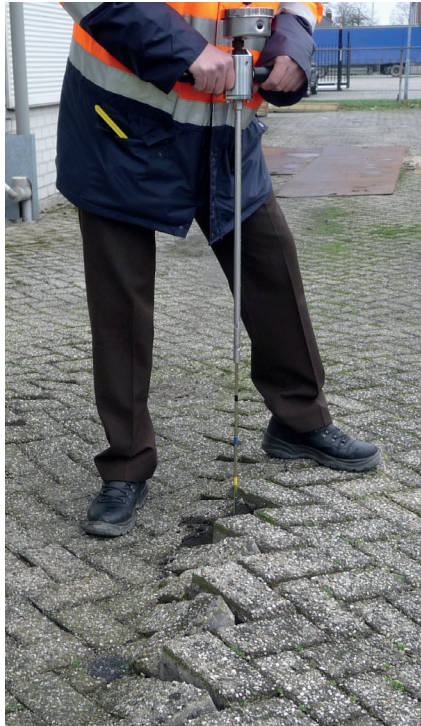
Afb. 3 Fundering: meting verdichting zandbedding handsondeerapparaat met kleinste conus (opp. 1 cm 2 ) en meeneemwijzer op 600 N dit is 6 Mpa op diepte van 30 cm.
